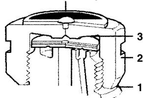
Le versioni TD 32FA e TD 32FALC sono equipaggiate con l'otturatore a disco antibloccaggio da aria
