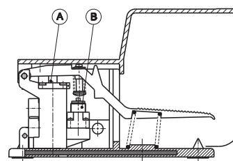
Il pedale aziona direttamente A , o con asservimento pneumatico B.
