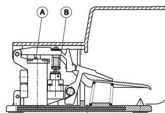
L'azionamento è possibile solo premendo contemporaneamente i due pedali. Rilasciando avviene il ritorno. L'applicazione è adatta per evitare azionamenti accidentali.
