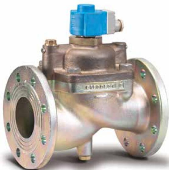
L'EV220B 65-100 è una serie di elettrovalvole a 2/2 vie per l'utilizzo in applicazioni industriali robuste e che richiedono alte portate. La valvola è progettata con un corpo valvola in ghisa e collegamento a flangia. Lo smorzamento del colpo d'ariete e un filtro pilota incorporato assicurano un funzionamento affidabile.
